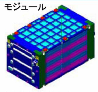
冷却機能:自然空冷 外形寸法:311x178x148 mm
