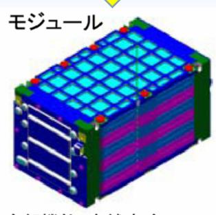
冷却機能:自然空冷 外形寸法:311x178x148 mm 16 modules in a car
